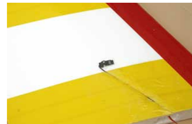
Fast verloren muss sich das Dymond DS 1550-Servo vorkommen, das die Steuerung der Quer-/Höhenrunder übernimmt. Ein kleiner Einschnitt in der Tragfläche lässt das Servokabel verschwinden, etwas Tape darüber und die Festigkeit ist wieder hergestellt
