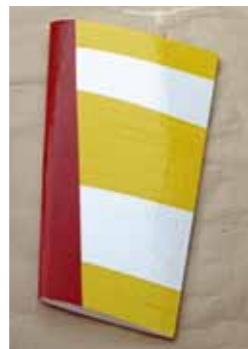
Auf der Oberseite wurde eine auffällige rot-gelbe Bespannung mit Tape gewählt
