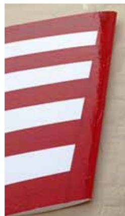
Die Unterseite der Tragfläche ist in Rot-weiß gehalten, das ergibt einen guten Kontrast zur Oberseite und fördert die Fluglagenerkennung. Das rote und gelbe Tape kann mit einem Fön oder Folienbügeleisen nachgespannt werden, jedoch darf die Temperatur 90 Grad Celsius nicht überschreiten
