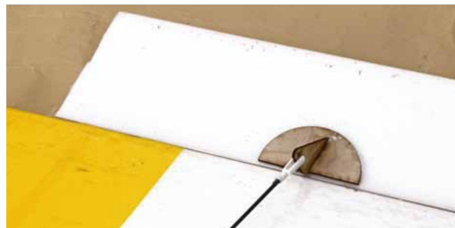
Damit die Ruderkräfte gut in die Quer-/Höhenrunder eingeleitet werden können, sind unter den Ruderhörnern Verstärkungen aufgeklebt. Hier sollte man unter den halbkreisförmigen Verstärkungen das Tape entfernen
