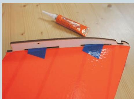
Mit Belzell wird die Kufe geklebt
