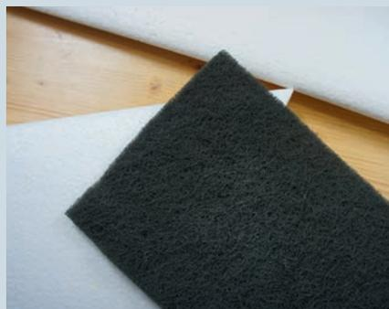
Vor dem Bekleben wird das Styropor mit Schleifvlies angeschliffen
