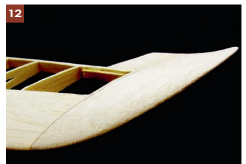
08 Ein 3D-Modell der Germania in FLZ-Vortex [1] 09 Zur Akkueinführung wird eine kleine Haube ausgeschnitten 10 Rumpffende mit strömungsgünstiger Zuspitzung – hier mit testweise montiertem Ruderhorn 11 Die Tragfläche lässt sich dank durchdachter Bauweise zügig aufbauen 12 Die Tiptlet-Randbögen sind mit einem Verwindungswinkel von bis zu circa -3,5 Grad geformt
