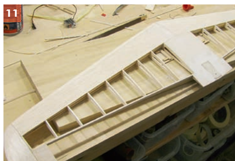
08 Ein 3D-Modell der Germania in FLZ-Vortex [1] 09 Zur Akkueinführung wird eine kleine Haube ausgeschnitten 10 Rumpffende mit strömungsgünstiger Zuspitzung – hier mit testweise montiertem Ruderhorn 11 Die Tragfläche lässt sich dank durchdachter Bauweise zügig aufbauen 12 Die Tiptlet-Randbögen sind mit einem Verwindungswinkel von bis zu circa -3,5 Grad geformt
