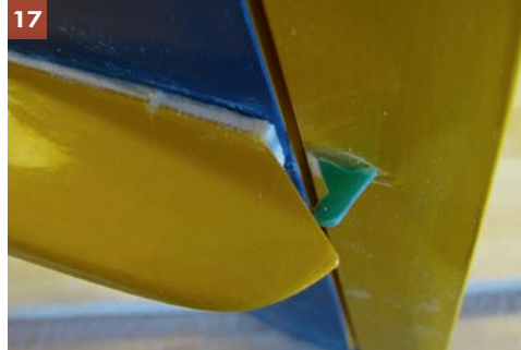
13 Das vorgesehene 3-mm-Sperrholzbrettchen (im Vordergrund) wurde gegen ein 0,5 mm starkes ausgetauscht 14 Die Querruderservos werden mittels Alu-Lasche verschraubt 15 Die Rumpfservos und die Aufnahme für den Empfänger 16 Der Bowdenzug zur Seitenrunder-Anlenkung besteht aus 0,8-mm-GFK mit einem angeklebten Stahlhäkchen 17 Zum Erreichen der berechneten EWD wurde ein kleiner Unterlegkeil am Leitwerk erforderlich 18 Die Anbringung der Endleiste ist unkonventionell aber gut gelöst
