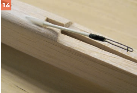
13 Das vorgesehene 3-mm-Sperrholzbrettchen (im Vordergrund) wurde gegen ein 0,5 mm starkes ausgetauscht 14 Die Querruderservos werden mittels Alu-Lasche verschraubt 15 Die Rumpfservos und die Aufnahme für den Empfänger 16 Der Bowdenzug zur Seitenrunder-Anlenkung besteht aus 0,8-mm-GFK mit einem angeklebten Stahlhäkchen 17 Zum Erreichen der berechneten EWD wurde ein kleiner Unterlegkeil am Leitwerk erforderlich 18 Die Anbringung der Endleiste ist unkonventionell aber gut gelöst
