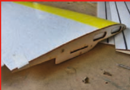
Um die Wurzelrippe während dem Aushärten zu fixieren, habe ich sie einfach aufgeschraubt. Außerdem ist hinten noch ein kleiner Klebebandstreifen angebracht.
