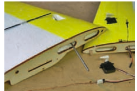
Die Servos habe ich beim zweiten Testmodell liegend eingebaut, die Kabelkanäle werden durchstoßen.
