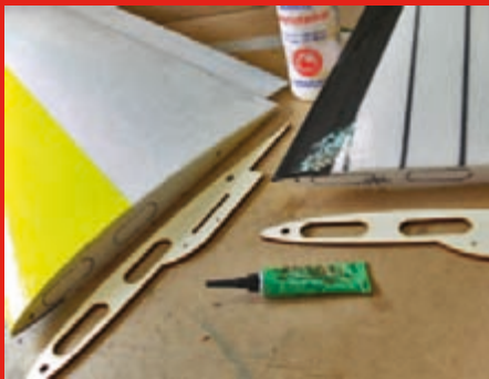
Bereit zum Verkleben der Wurzelrippe. Weißleim ist hierbei mein favorisierter Kleber, Beli-Zell schäumt halt ziemlich auf.
