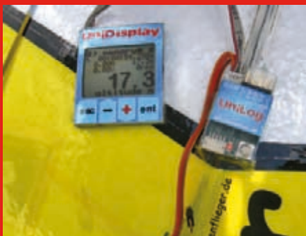
Mit UniLog dokumentiert: Die Wurfhöhe beträgt bei einem durchschnittlich sportlichen Wurf zwischen 15 und 20 Meter, wobei gerade die letzten 1 – 2 Meter viel an der Gesamtflugzeit ausmachen können, da es so meist einfacher wird, Thermikanschluss zu finden.
