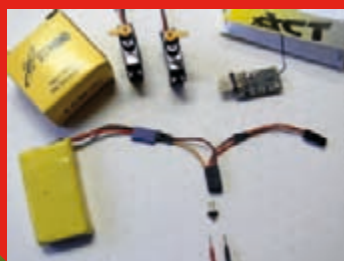
Das für die direkte LiPo-Empfängerstromversorgung geeignete, 8-Volt-taugliche RC-Zubehör mit Dymond D 60 Servos, ACT 2,4-GHz-Empfänger, Lade- und Einschaltbuchse.
