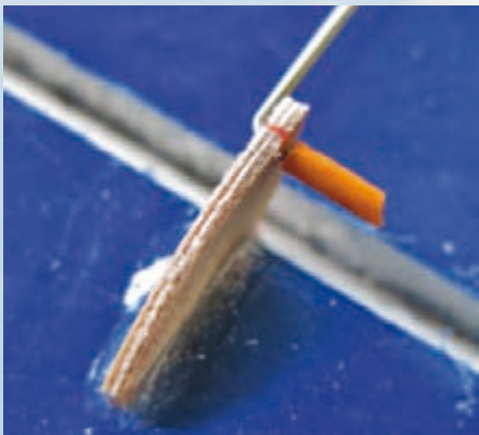
Die Querruderanlenkung: ein im Bausatz enthaltener Kunststoffschlauch...
