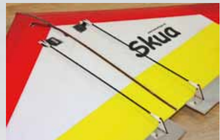
Die Servos sitzen auf der Oberseite des Flügels. Anlenkungsmaterial ist im Bausatz enthalten.
