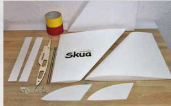
Der Lieferumfang. Die Styropor-Flächenkerne sind sauber CNC-heißdraht-geschnitten. Zwei Rollen Tape zum Bespannen liegen bei.
