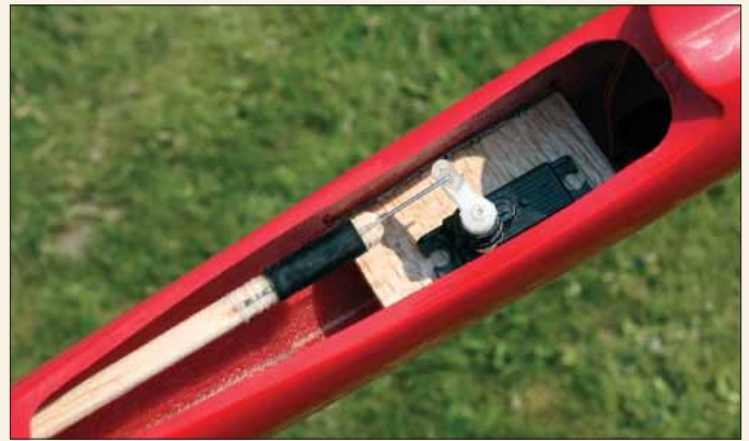
Aufgeräumt: Das Höhenruderservo sitzt im Schwerpunkt, Akku und Empfänger verstecken sich in der Spitze
