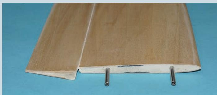
Auch das V-Leitwerk ist fix und fertig, einschließlich der Steckung; deutlich zu sehen die CfK-Verstärkung
