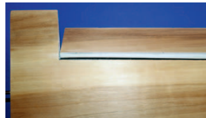
GFK-Spaltabdeckungen an den Klappen und Rudern, beim Asgard Standard
