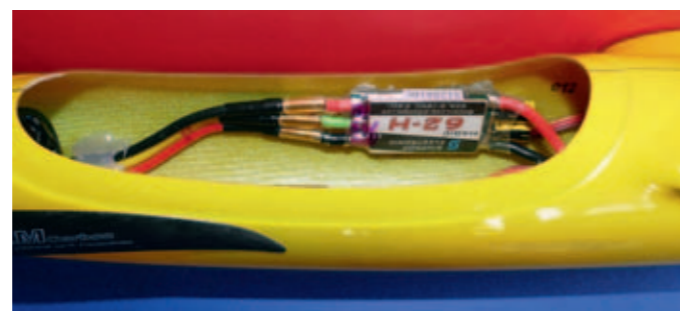
Links: FrSky G-RX8-Empfänger mit Vario, ein kleiner Vielkönnner. Rechts: Der dünne Regler Simprop 62H lässt viel Breite für den Flugakku
