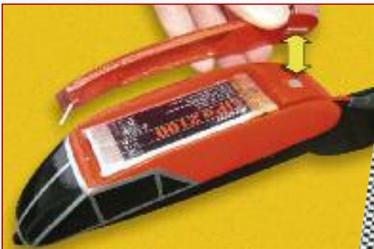
▲ Der Deckel wird vorn über einen kurzen Stahldraht fixiert und hinten mittels Magnet und Blechstreifen (siehe gelber Pfeil) gehalten. Das Akkukabel wird über einen Schlitz nach hinten zum Drehzahlsteller geführt.
